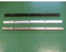
アルミ パイプ穴加工
