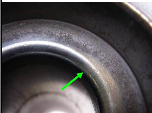
アプセット鍛造用下型 (SKD61) 4000本鍛造後でも角ダレが少ない。
