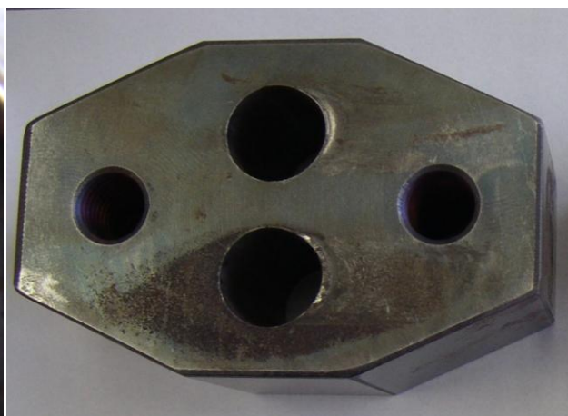
鉄筋切断刃物 40,000本切断後の外観
