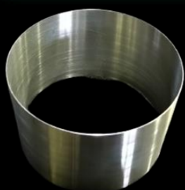
薄物パイプ加工
